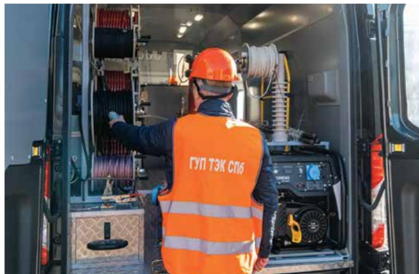
кабеля, материал под действием тока мог заплывать повреждение внутри муфты, но с новой лабораторией такие «заплывающие» повреждения разрушаются, и с помощью локатора быстро можно обнаружить место повреждения», — рассказал начальник Электротехнической лаборатории ГУП «ТЭК СПб» Илья Краевский.
