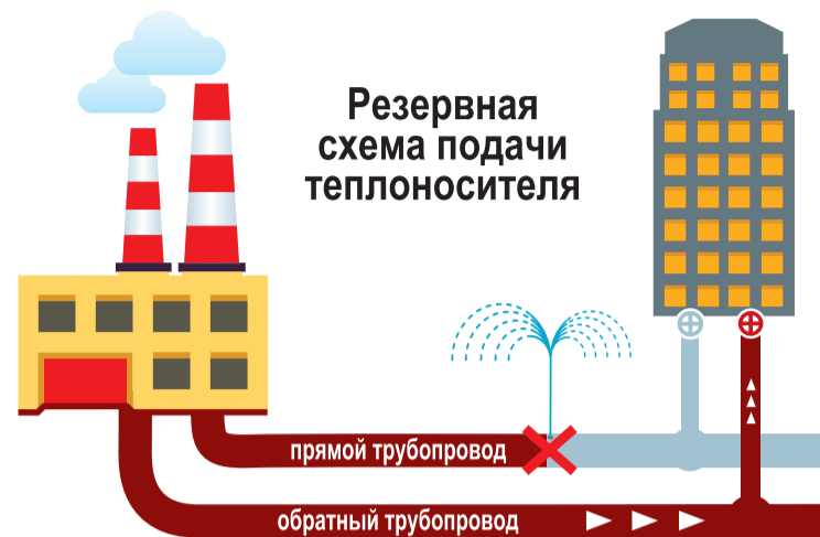
Подача ГВС по обратному трубопроводу
