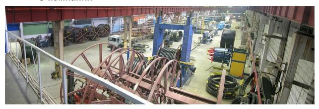
АО "Завод Полимерных Труб", участник холдинга ПО "ТВЭЛ", является одной из ведущих российских и мировых компаний, осуществляющей производство гибких изолированных трубопроводов. Компания осуществляет производство и поставку труб ТВЭЛ-ПЭКС для наружных сетей отопления, горячего и холодного водоснабжения с функциональной трубой из сшитого полиэтилена РЕХ-А, с антикислородным диффузи онным барьером,
