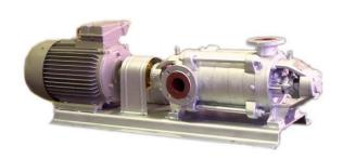
Агрегаты электронасосные типа "КГВ" - центробежные, горизонтальные, консольные, одноступенчатые - предназначены для перекачивания перегретой воды с водородным показателем рН 8...9, с содержанием механических примесей не более 0,1% по массе и с размером твердых частиц не более 0,1 мм. Уплотнение вала насоса - торцовое или мягкий сальник.
